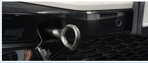
2. أدخل حلقة الجر في فتحة حلقة الجر، وقم بتدويرها في اتجاه عقارب الساعة، وقم بشدها.
