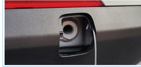
2. أدخل حلقة الجر في فتحة حلقة الجر، وقم بتدويرها في اتجاه عقارب الساعة، وقم بشدها.
