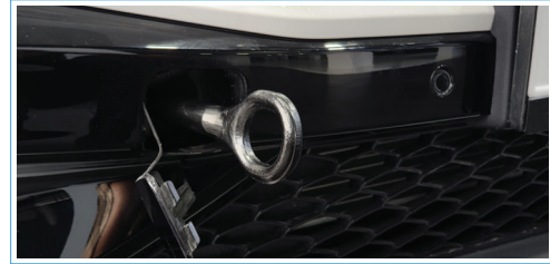
مكان تركيب حلقة الجر الخلفية مكان تركيب حلقة الجر الخلفية موجود في الجزء السفلي من الجانب الخلفي الأيمن للمركبة.
