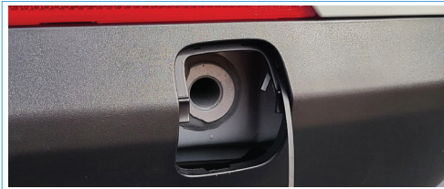
2. הכנס את טבעת הגרירה לתוך קדח טבעת הגרירה, סובב אותה בכיוון השעון, והדק אותה.
