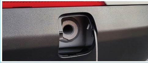
2. أدخل حلقة الجر في فتحة حلقة الجر، وقم بتدويرها في اتجاه عقارب الساعة، وقم بشدها.
