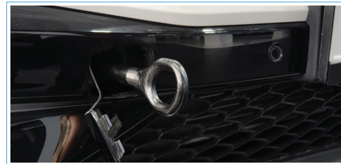
2. הכנס את טבעת הגרירה לתוך קדח טבעת הגרירה, סובב אותה בכיוון השעון, והדק אותה.
