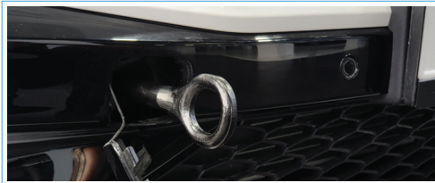
2. הכנס את טבעת הגרירה לתוך קדח טבעת הגרירה, סובב אותה בכיוון השעון, והדק אותה.
