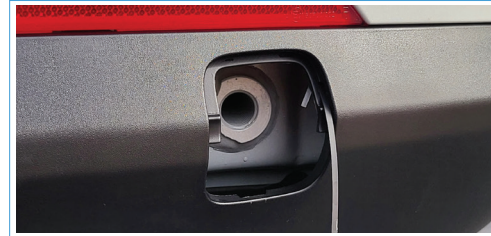
2. הכנס את טבעת הגרירה לתוך קדח טבעת הגרירה, סובב אותה בכיוון השעון, והדק אותה.
